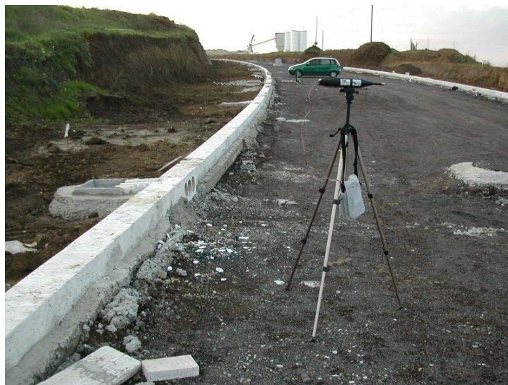
MISURE FONOMETRICHE CON DOPPIO FONOMETRO IN CLASSE I
